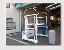
架台を組んで垂直ゲートを組み込んでバッテリーユニットを載せたモノで、キャスターがついているので、文字通り人力での可搬が可能。
