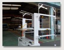
使い方は超簡単! 荷台のリヤドアを開いたらこの可搬式ゲートをトラックのテールにセット。 あとは、普通のテールゲートのように扱うだけ。
