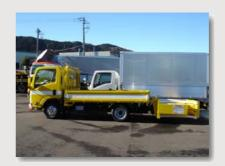
軽量アルミ合金による ハニカム構造になって おり、これが潰れること で後方からの衝突を受 け止め、時速70kmで 一般車が衝突しても車 を包み込むように衝撃 を吸収し、現場の2次災 害を防ぐことができます。
