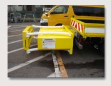
車を包み込むように受け 止めるため他の車線への 影響も最小限に留めることができ、部品の飛散も低 減できるので、事故による 通行止めのリスク軽減や、 事故からの復旧にかかる 時間の短縮など、道路イン フラ業界に与えるインパク トは絶大です。
