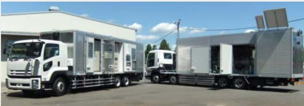
3600キロワット(一般家庭1万戸分)の最大出力を擁するとともに、起動後約40秒で発電を始めることができる優れた応答性も具え、原子力発電所のバックアップ電源に適しております
