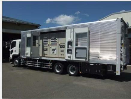
制御車には制御装置と蓄電池、燃料タンクが組み込まれ、この2台が1組になって行動し、コンパクトで機動性に富んだ発電システムとなっております
