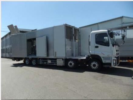
電源車には英ロールスロイス製の航空向けジェットエンジンを発電用に改良した一軸式ガスタービンが搭載されています
